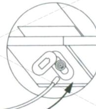
После полной зарядки батареи плотно закройте заглушку разъёма зарядки
